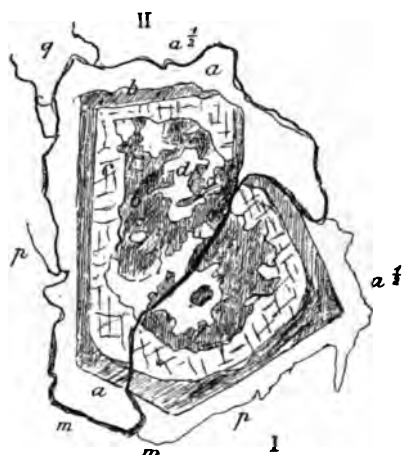
Fig. 6. Dessin schématique de la face g^A (010) du cristal zoné représenté par les photographies de la page suivante (fig. 7 et 8).
