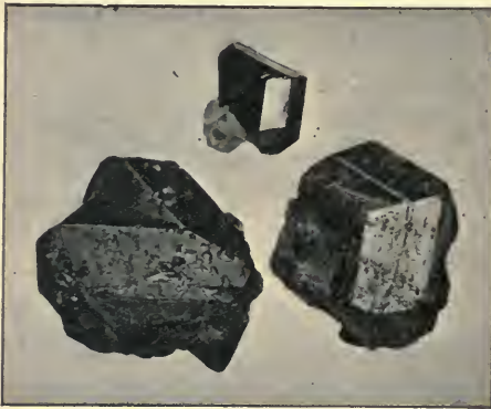
Fig. 14 à 16. Cassitérite de la Villeder. Macles suivant a^1 , dont les figures théoriques sont représentées par les figures, 8 (en haut), 12 (à gauche), 6 (à droite). Photographie grandeur naturelle.
