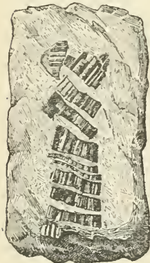
Fig. 20. Cristal de tourmaline du marbre de Saint-Béat écrasé et brisé.
